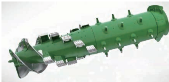
图3 纵置轴流脱粒分离装置
