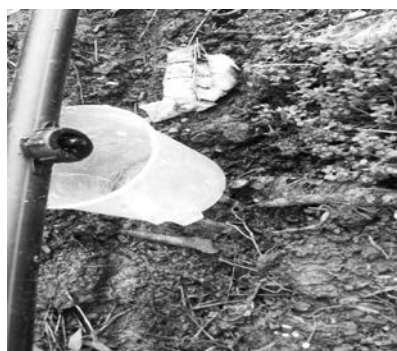
图5 滴头流量均匀性试验
